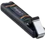
Kabelmesser zur schnellen Abmantelung aller gängigen Rundkabel von 4–15 mm Ø, Umstellung von Rundschnitt auf Längsschnitt erfolgt durch das drehbare Innenmesser automatisch
