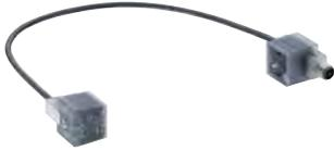
Doppelmagnetventiladapter (ein Ventiladapter mit integriertem M12-Einbaustecker) nach DIN EN 175301-803, Bauform A, mit LED und Varistor als Schutz gegen Überspannungen, Erdanschluss gebrückt
