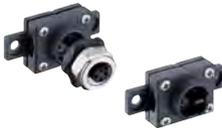
AS-Interface Leitungsverbinder, verwendbar als Abgriff-Verteiler oder Stecker, wiederverwendbare Eindringtechnik nach IEC 68 und DIN 41611, Sechskantmutter aus Edelstahl, 4-polig. AS-Interface Abgriff 0911 ANC 415 ist im Lieferumfang des 0911 ANC 413 enthalten.
